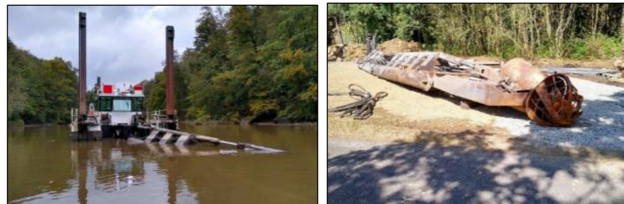
FIGURE 11 : DRAGUE ASPIRATRICE STATIONNAIRE ET SON CUTTER (SOURCE : INGEROP, 2020)
